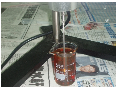
圖 3-19 以黏度計測量生質柴油黏度
