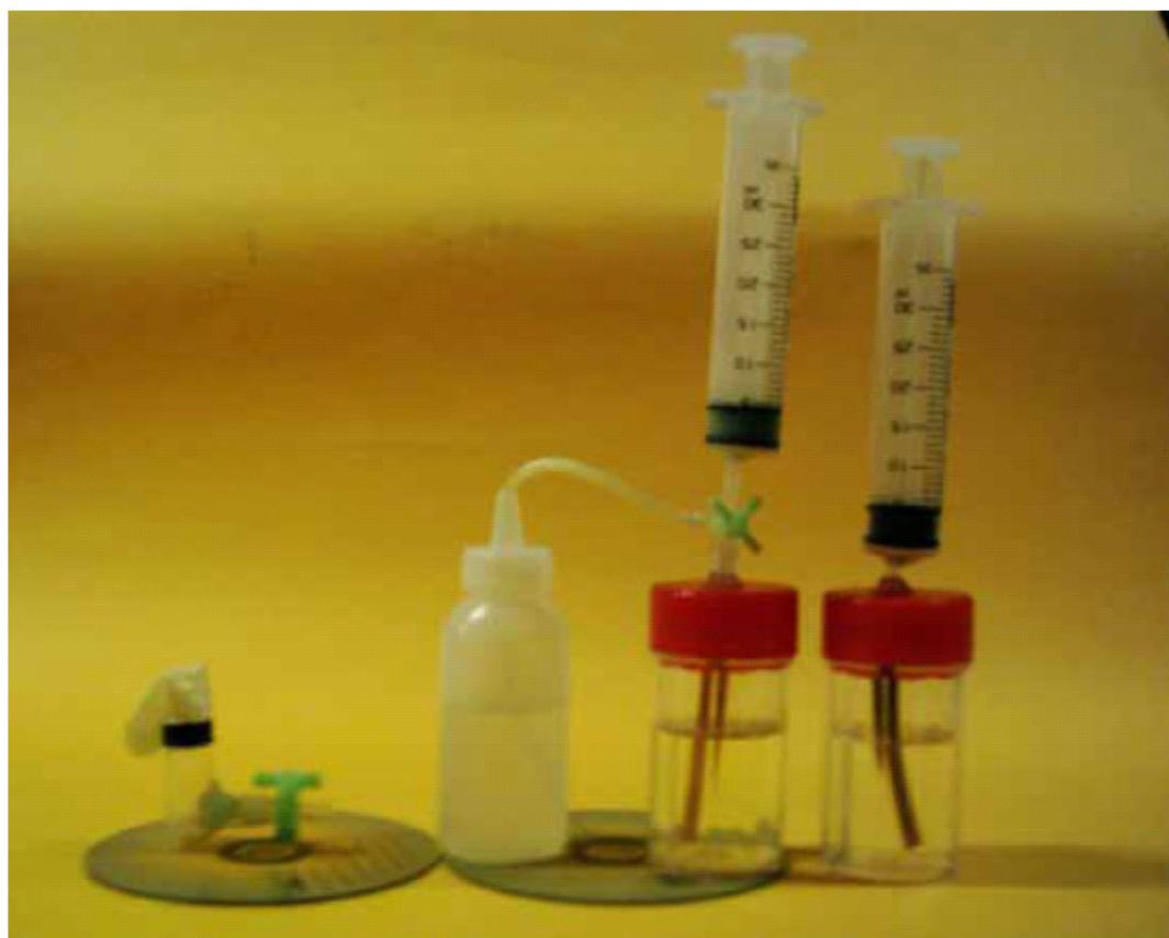
照片 6 「微型氮氣光化反應裝置」
